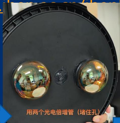
用两个光电倍增管 (堵住孔)
